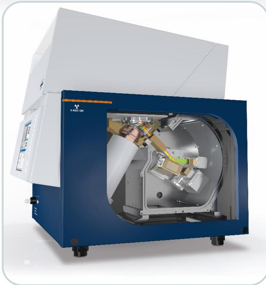
Aufbau eines kompakten WDRFA mit hoher Auflösung
